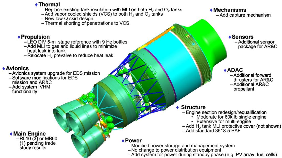
**Figure 1-3. EDS Subsystem Impacts**
